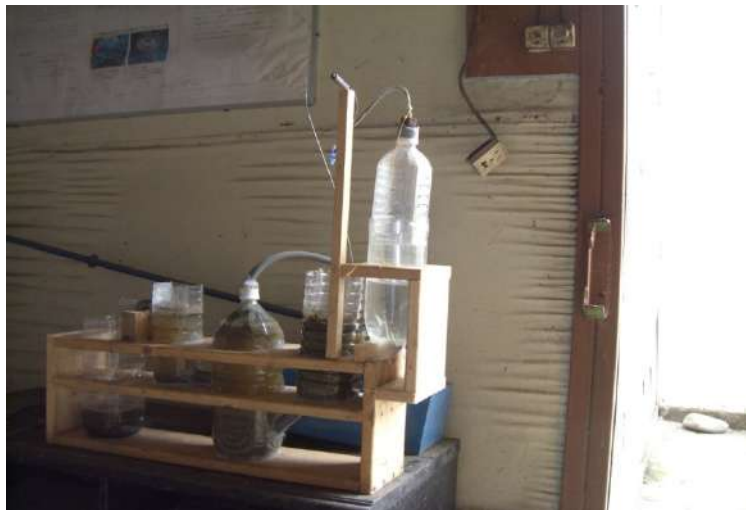
↑ バイオガス抽出装置
